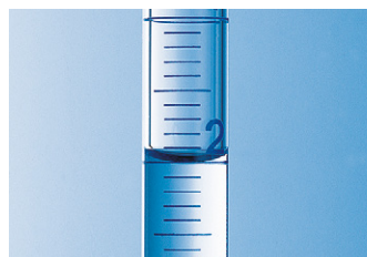
Ménisque concave dans une pipette graduée.
